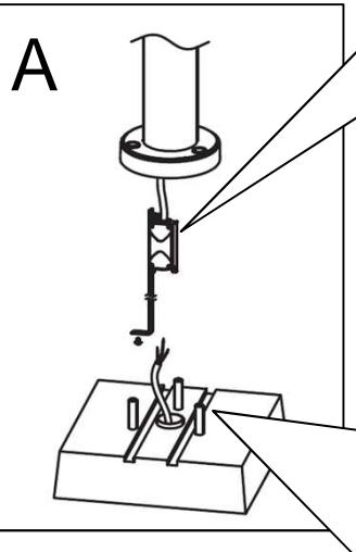
**ATTENZIONE:** I 3 perni di fissaggio nel plinto/terreno devono garantire il sicuro fissaggio dell'apparecchio.
