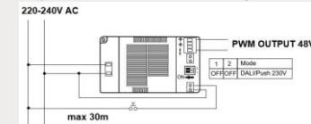
**NOTA TECNICA:** L'alimentatore a 48V di Potenza pari a 75W è utilizzabile solo con le luci sospensione cilindriche e modulari, e dovrà essere posizionato esternamente ai binari in un vano dedicato.
